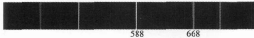
图3 氦气的发射光谱.其中波长为588 nm的黄线具有最大的强度,它同钠黄光双线(589.0nm和589.6nm)极为接近
